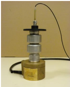
Figure 9: Dispositif expérimental appliqué à la qualification d'un silencieux de turbo
