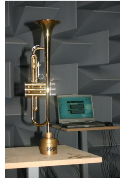
Capteur à source de débit contrôlée (CTTM)
