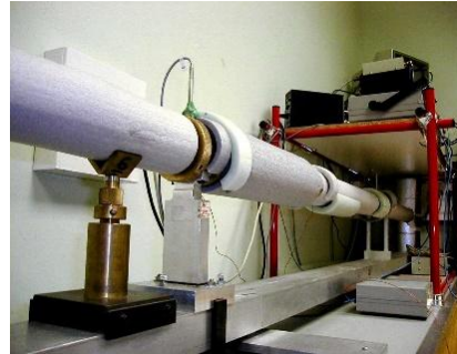
Tubes de Kundt (méthode Chung et Blaser ou TMTC)
