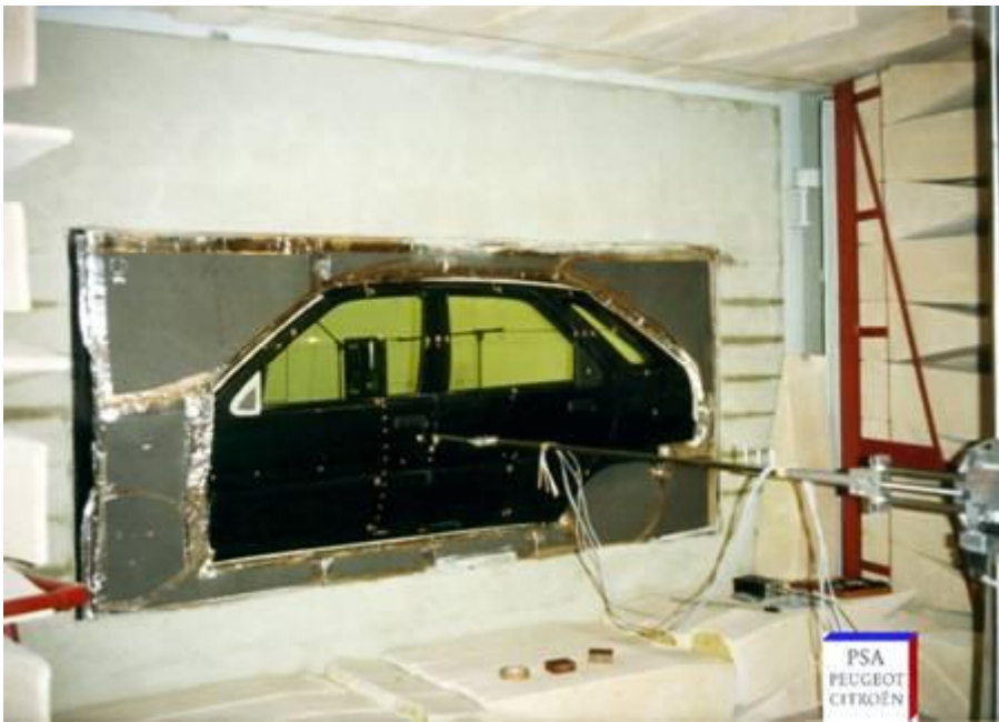
Mesure 3D avec balayage robot
