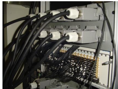
Frontal d'acquisition et conditionneurs (120 voies de mesures)
