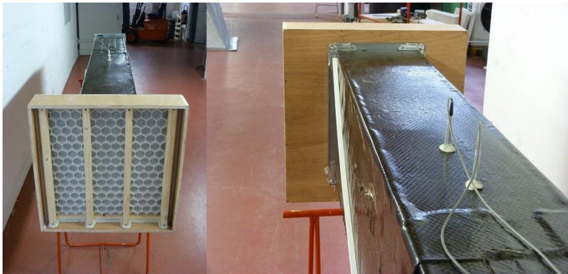
Figure 4 : Terminaison anéchoïque résistive
