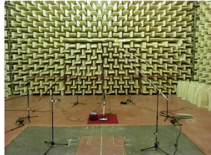
Mesures en salle semi-anéchoïque Conditions de champ libre sur plan réfléchissant Norme ISO 3745
