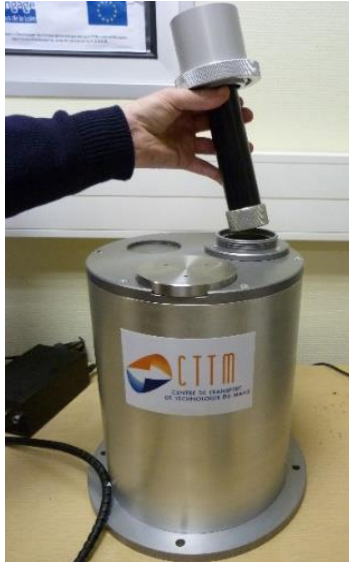
Terminaison anéchoïque encapsulée ( Z_A )
