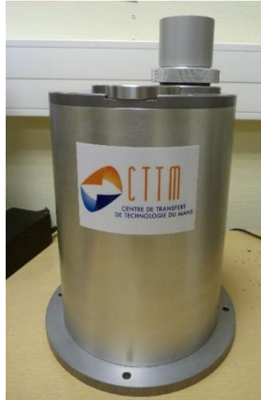
Terminaison anéchoïque encapsulée ( Z_A )
