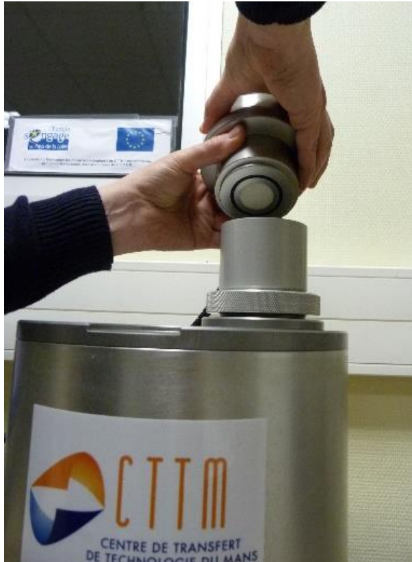
Mesure de l'impédance Z_S^A avec charge anéchoïque (sans manipulation de l'échantillon)
