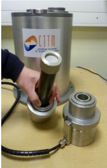
Terminaison anéchoïque encapsulée ( Z_A )
