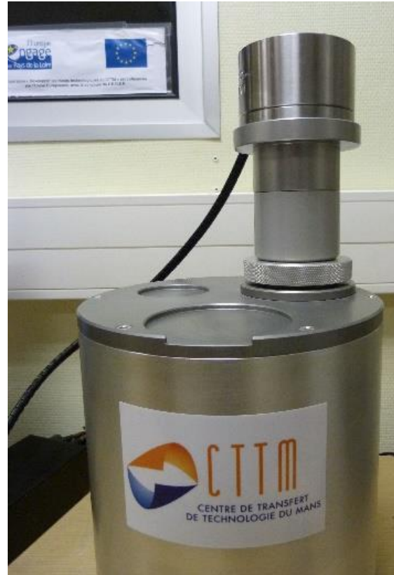
Mesure de l'impédance Z_S^A avec charge anéchoïque (sans manipulation de l'échantillon)
