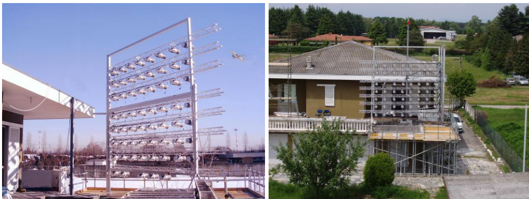
Figures 12 : vues de l'antenne équipée de 56 actuateurs
