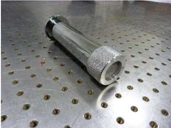
Terminaison anéchoïque résistive pour tube à impédance de diamètre 45mm
